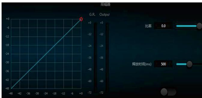
也叫限制器，它只有一个关键任务：无论在什么情况下，确保信号不会超过门限电平。通过调整压缩器的控制参数，可以让它的工作方式与限制器非常相似。限制器工作原理的核心，是它真正关系门限电平以下的信号内容，以及在信号发生过冲之前增益衰减量是如何开始产生的。限制期通过两个处理阶段来完成相应的处理，在第一个阶段只是进行比较轻微的限制，但是并不会处理过冲信号，然后在第二阶段，如果信号产生了过冲，它们就会以非常剧烈的方式进行衰减。
