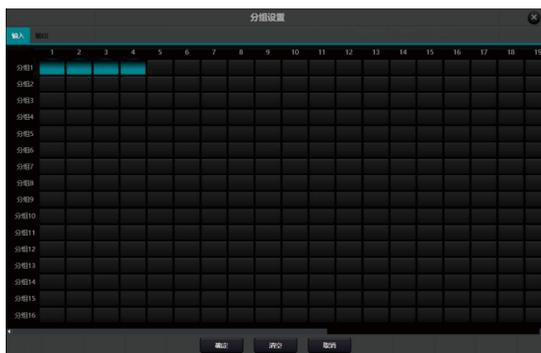
共16个分组，每一个分组可选择1-设备最大通道数。设备最大通道数取决您购买的型号而定。通道设置成一个分组，在主界面该分组将以一个颜色区分。
