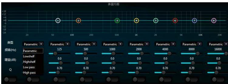
**类型：**默认参量均衡，可选高低架滤波器和高低通滤波器。每一种滤波器有不同的形态，可完成不一样的功能。
