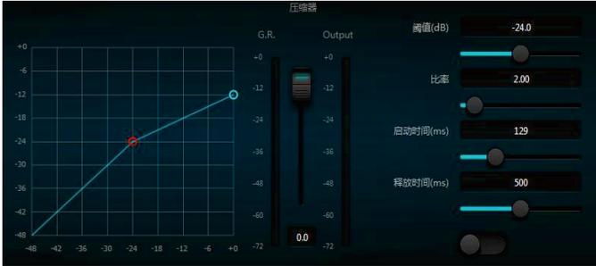
**阈值：**信号电平高于此值时压缩器/限制器开始降低增益,任何超出阈值的信号都会被认为是过冲信号,并且在正常情况下其电平会被减少。信号超出阈值的范围越大，电平被衰减得也就越多。
