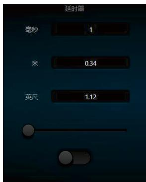
**激活按钮：**在模块中激活指定的延时模块，将其插入到音频信号路径中，对信号增加固定的延时时间。
