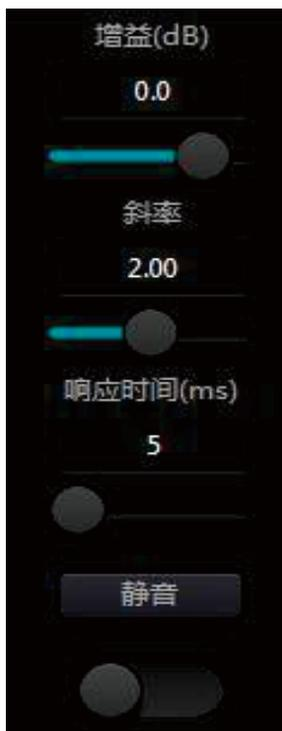
最下面的按钮打开或关闭自动混音的功能
