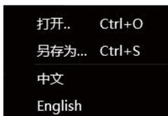
在脱机模式下，点击打开弹出文件对话框选择，打开一个已存在的预设文件(后缀名: \*.uma)。也可以右键预设文件，使用DSP.exe应用程序打开。“另存为”将应用程序上的预设存到本地硬盘上去，方便拷贝，存储。仅支持中文设置。
